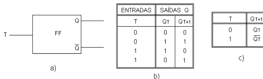
Figura 5 - Flip-Flop T - a) Símbolo - b) Tabela de Funcionamento - c) Tabela Resumida
