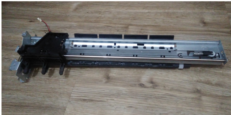
Figura 5: Corredeira retirada de uma impressora velha, com ela vieram 2 motores DC, um para controle do trilho e outro para o módulo que roda permitindo controle da troca de linha da folha A4.
