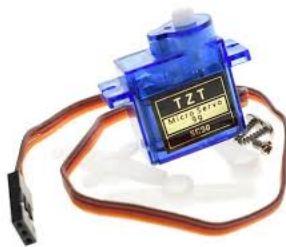
Figura 7: Micro Servo Motor SG90 utilizado para controle da caneta tocar no papel.
