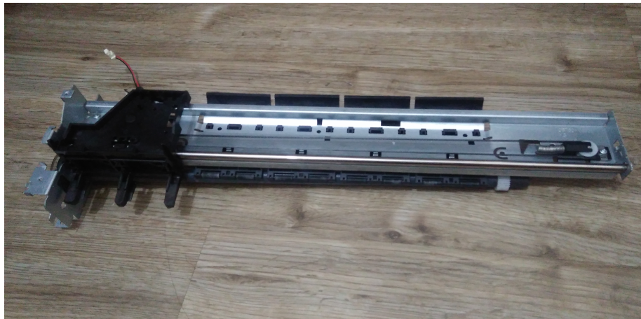
Figura 6: Corredeja retirada de uma impressora velha, com ela veio 2 motores DC, um para controle do trilho e outro para o módulo que roda permitindo controle da troca de linha da folha A4.
