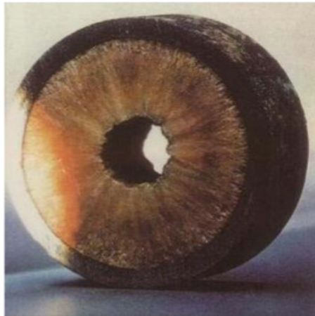
Figura 1 – Parafina despositada na parede interna de oleoduto Fonte: STATOIL (2011)
