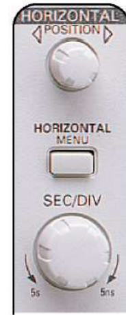
Figura 5: Controle horizontal do TDS220 da Tektronix
